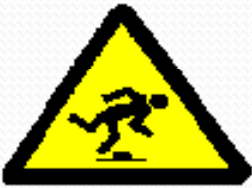
Riesgo de tropezar
